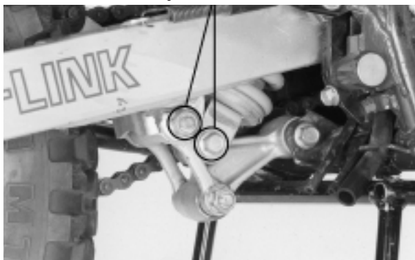
PARAFUSO DE FIXAÇÃO DO AMORTECEDOR
