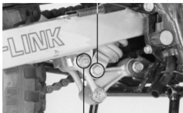
PARAFUSO DE UNIÃO DA HASTE DE CONEXÃO COM O BRAÇO OSCILANTE
