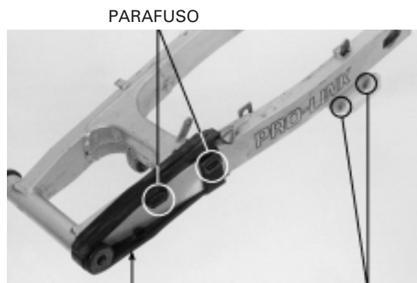
PARAFUSO SAPATA DA CORRENTE DE TRANSMISSÃO
